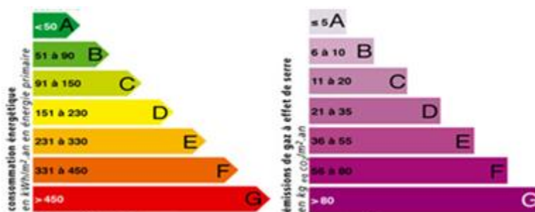
Figure 3-12: Etiquettes d'un DPE d'un bâtiment tertiaire (bureaux et services administratifs, et bâtiments d'enseignement)
